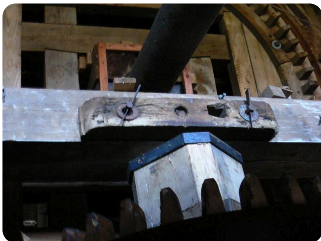
Flügelwelle, Achsrad und Bunkler in der Kappe · Foto: Vereinsarchiv 2007
